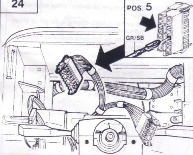
**16-Polige konnektor:** sluit de dashboard draadboom GR/SB aan (pos. 5).
